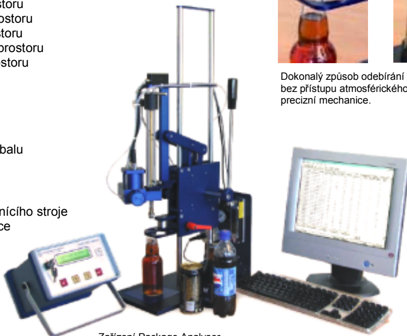
Zařízení Package Analyser se zobrazovací jednotkou a počítačem pro zpracování naměřených údajů.
